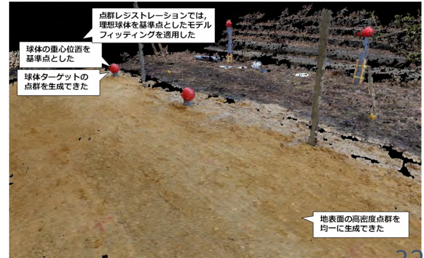
高解像度カメラ画像から生成した点群
