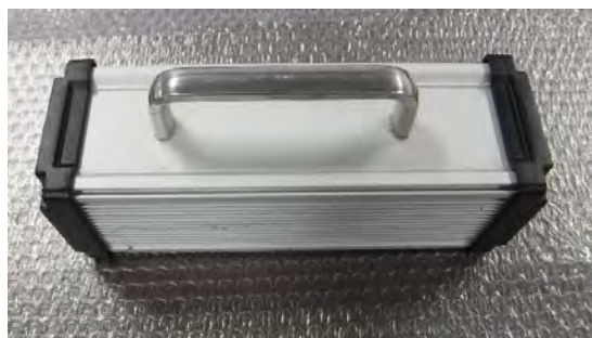
RI密度計（試作機） （セシウム137、CsIシンチレータ）
