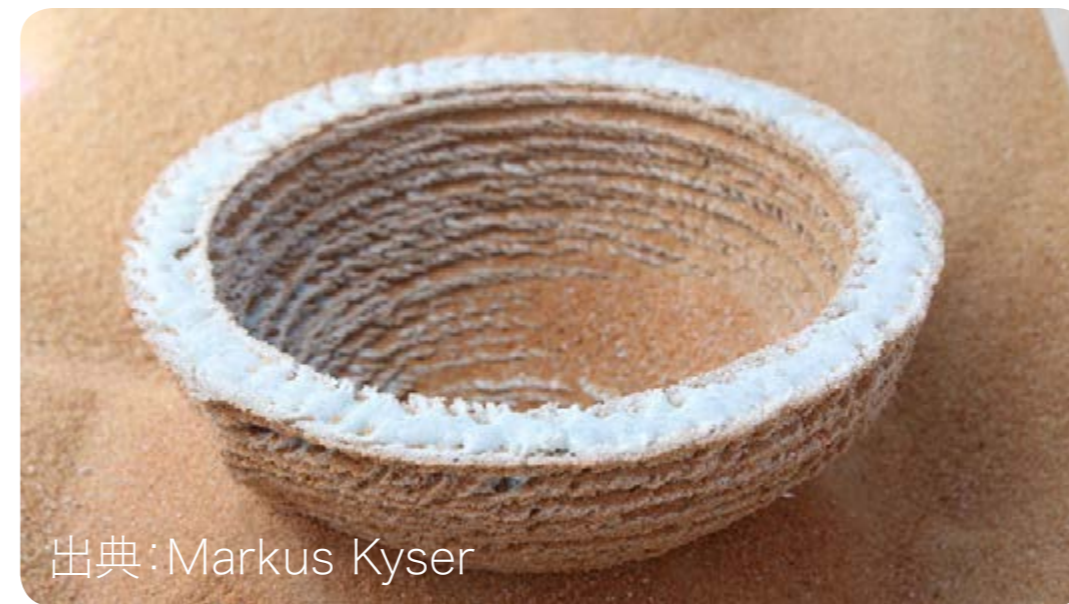
粉末焼結(燃結)方式3Dプリント：加熱により原子同士が接合する現象を利用
