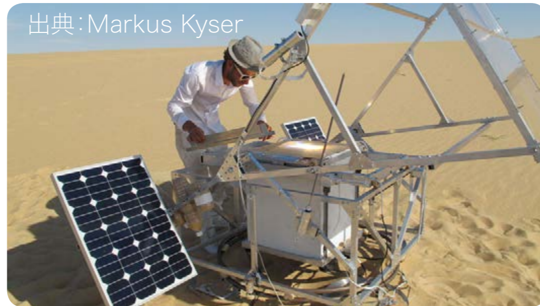
粉末焼結(燃結)方式3Dプリント：加熱により原子同士が接合する現象を利用
