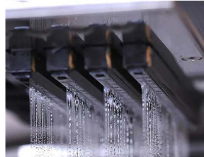
粉末固着方式は、石膏などの粉末材料を敷き詰めた上に、ヘッドを移動させて接着剤を吹き付けて固めていく方式
