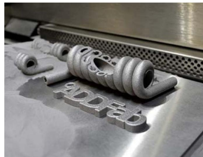
粉末状の材料にレーザー光線を当てて焼結させる方式
