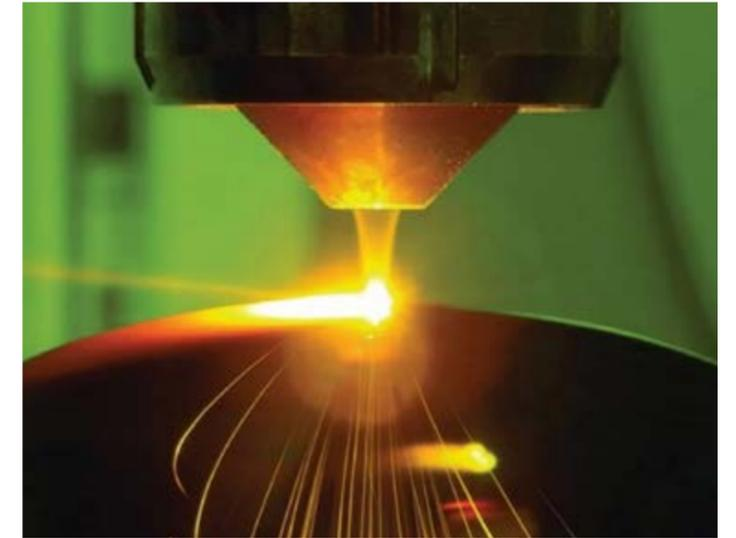
噴射ノズルから粉末を供給しつつ、同時にレーザーで熱を加える事で熔融結合していく造形方式
