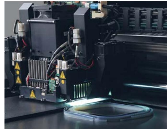
インクジェットヘッドから噴射した樹脂を、紫外線で固めて積層する方式
