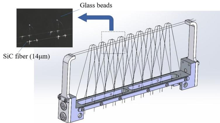
Fig. 2 Droplet array holder
